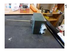
9 Differenzdruckmanometer Fischer Mess- und Regeltechnik DS1103VA22A1 Prod.-Nr. 710294.01.007 Messbereich 0-1,6 bar P stat. max 25 bar einseitig überdrucksicher bis 25 bar
